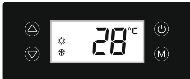
Wenn der Poolheizung in Betrieb oder im Standby ist, zeigt das Display die Wassereintrittstemperatur an.
