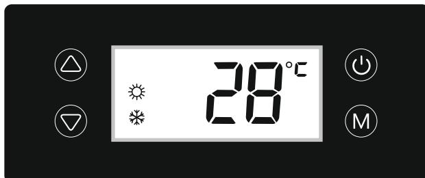
Vatteninloppets temperatur visas på displayen när poolvärmaren är i drift eller i standbyläge.
