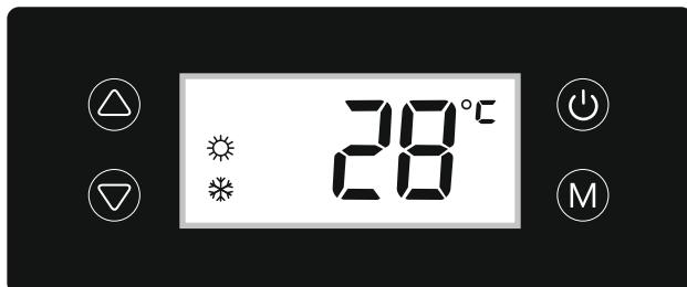
Amikor a medencefűtő berendezés üzemel vagy készenléti állapotban van, a kijelzőn a vízbemeneti hőmérséklet jelenik meg.
